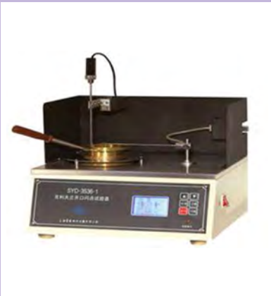
Рис. 1 – Тестер SYD-3536-1 для определения температуры вспышки в открытом тигле
