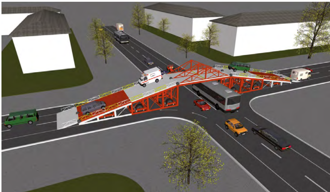
Рис. 1 – Мобильный дорожный путепровод
