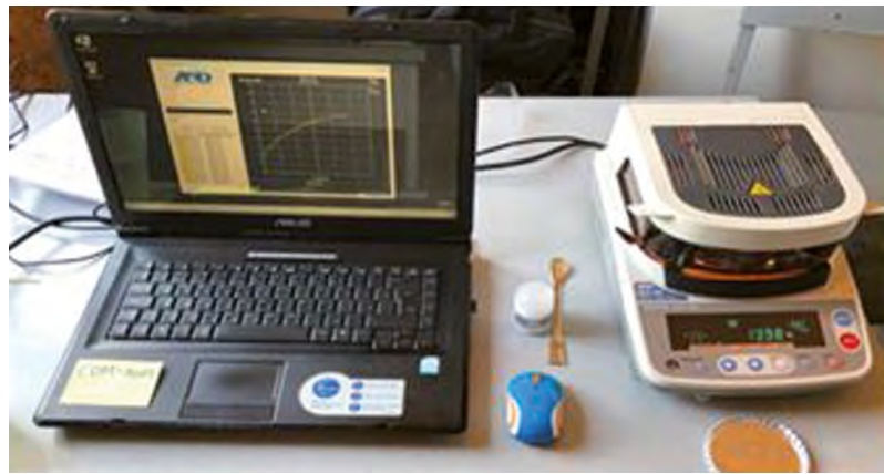
Рис. 2 – Проведение ТГА анализа при помощи прибора AND MX-50
