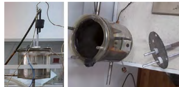
Рис. 6 – Калориметрическая бомба для определения теплотворной способности
