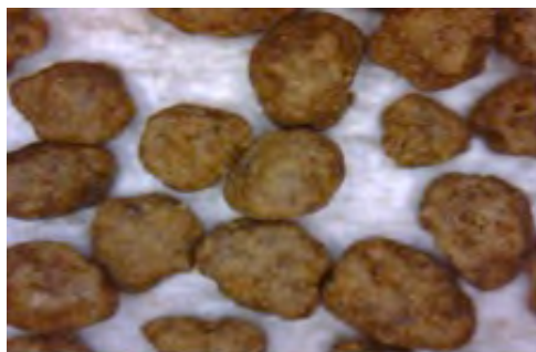
a) 120-кратное увеличение b) 2500-кратное увеличение Рис. 4 – Внешний вид полученных проппантов
