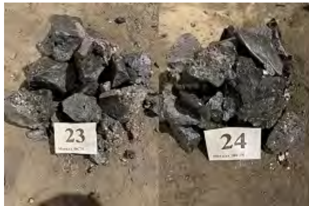
Рис. 4 – Фотографии металла, остывшего в естественных условиях
