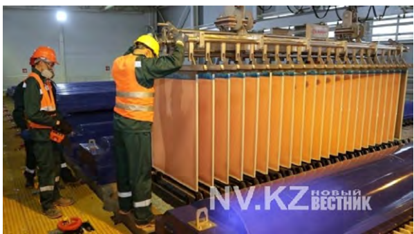
Рис. 6 – Катодная медь из окисленных руд месторождения «Алмалы»
