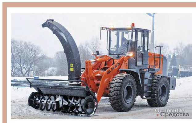
Сурет 1 – Шнек-роторлы қар тазалағыш
