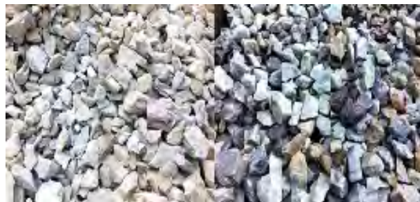
Рис. 2 – Вид исходного (а) и промытого (б) кварцита
