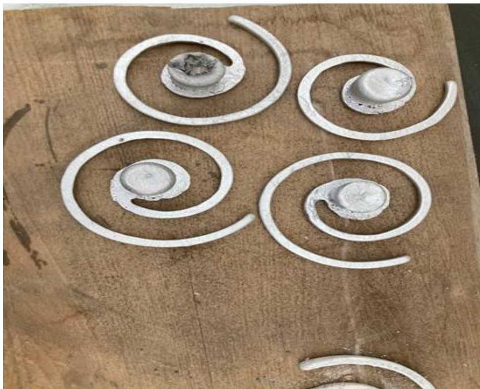
Рисунок 1 – Образцы для определения жидкотекучести алюминиево-литиевого сплава
