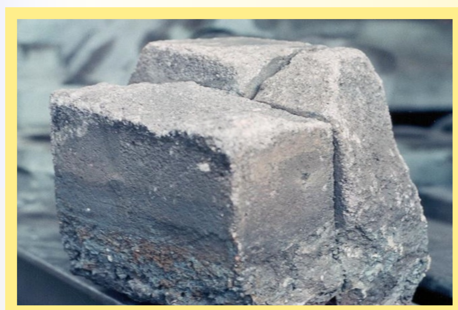
Омоноличивание кирпичей после использования
