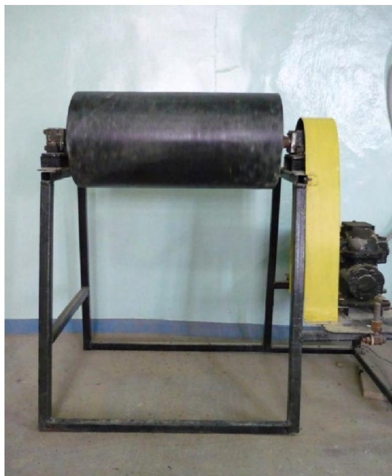
Рис. 1 – Лабораторный барабанный окомкователь
