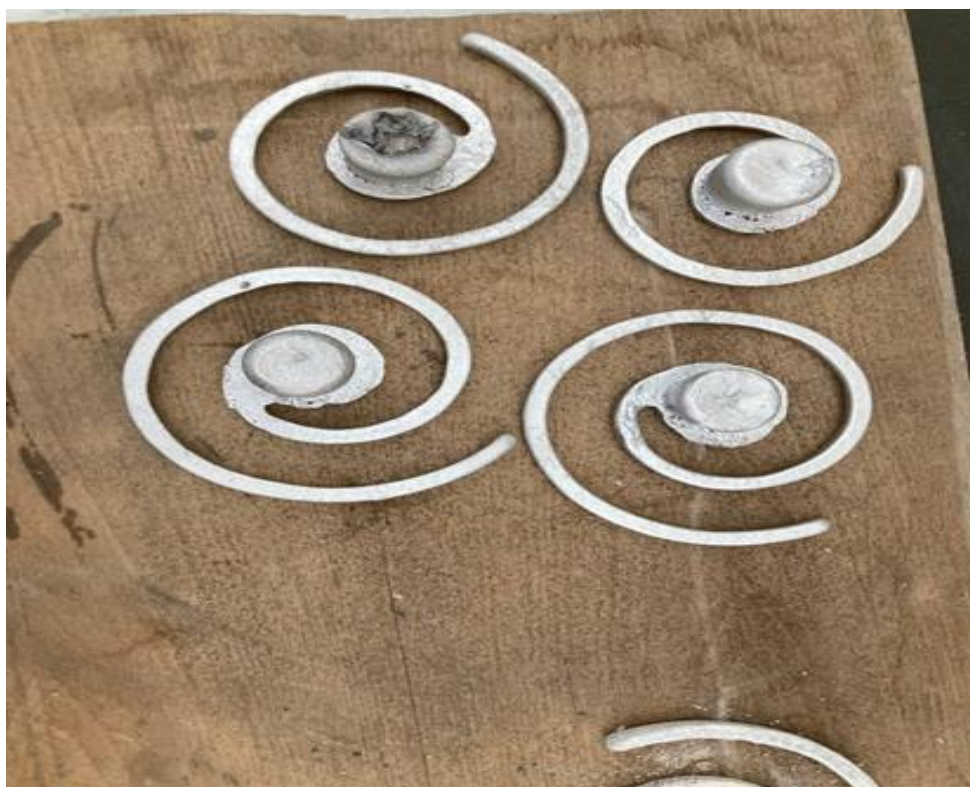
Рисунок 1 – Образцы для определения жидкотекучести алюминиево-литиевого сплава
