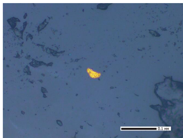
Рисунок 3 – Проба №2. Свободное золото в кварце. Ув. 200 (размер зерен 0,015x0,035 мм)
