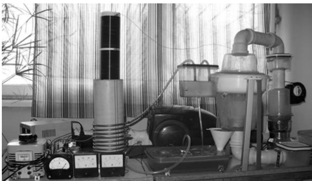
Рисунок 5 – Лабораторная установка объемного электрофизического воздействия на минералы в рабочем режиме
