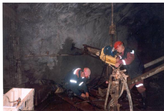
Рисунок 3 – Опытный образец ЭМП на промышленных испытаниях в забое Риддер-Сокольного рудника АО «Казцинк»
