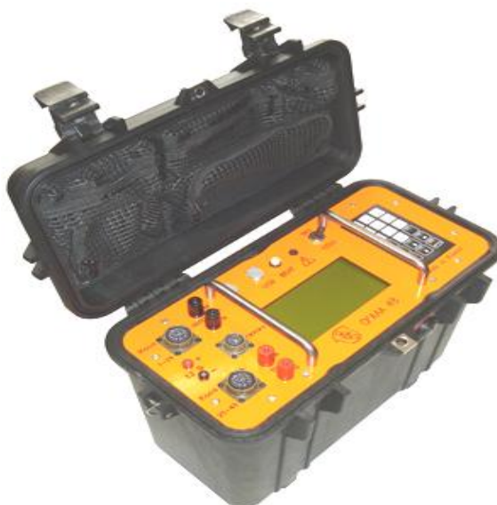
Рисунок 2 – Электроразведочная станция «Скала 48»
