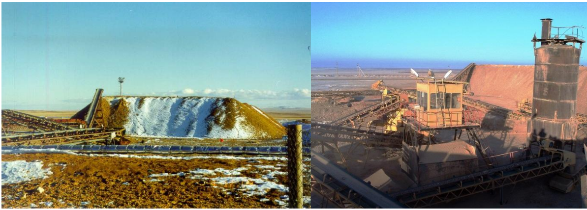
Рисунок 1 – Предварительное окомкование руды и укладка ее в штабель на рудниках Суздальский (а) и Северный Аркалык (б)
