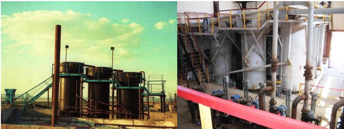
Рисунок 2 – Трехстадиальная каскадная схема сорбционных колонн на рудниках Центральный Карамурун и Узбой
