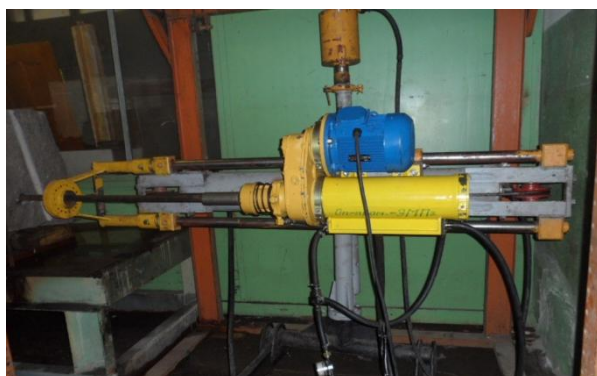
Рисунок 2 – Опытно-промышленный образец электромагнитного перфоратора на буровом станке ЛПС-3у
