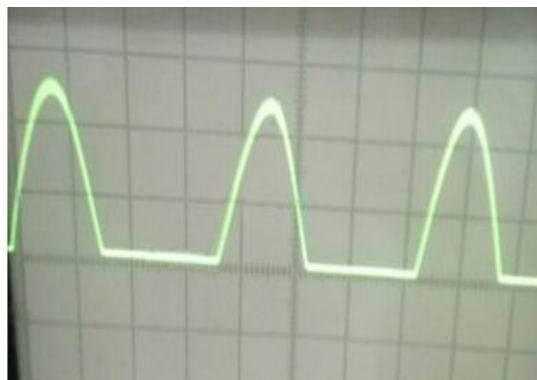
2 сурет – Жиілігі 50 Гц импульсті токпен поляризациялау кезінде ток амплитудасының уақытқа байланысты өзгеруі, i_{Ti} = 88 \text{ кА/м}^2
