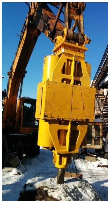
Рисунок 1 – Опытный образец электромагнитного молота, установленный на экскаваторе
