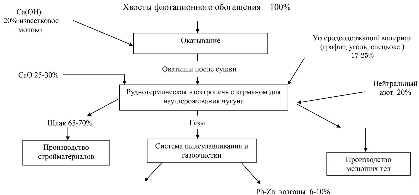
Рисунок 2 – Технологическая схема глубокого обеднения хвостов флотационного обогащения шлаков медеплавильных производств на ванне чугуна в руднотермической печи с выносным «карманом» для науглероживания
